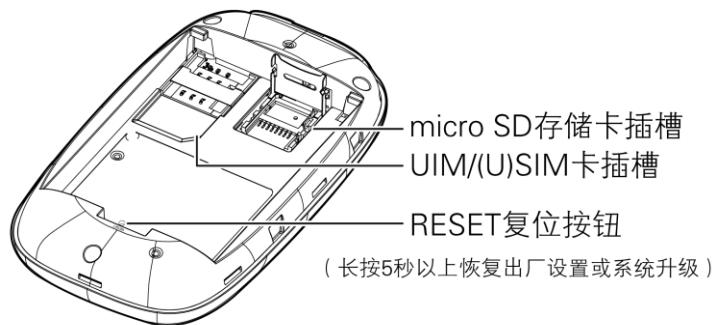
图 3.4 内部结构图
